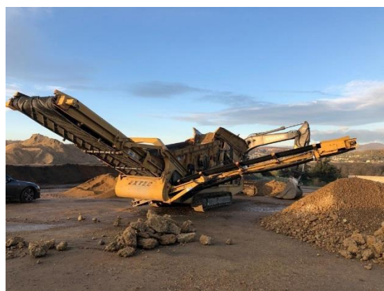
Scalpeur EXTEC E7 Année : 2006 – 7704 Heures – En Etat de fonctionnement Alimentateur métallique - Caisson vibrant équipé de doigts espacement 70 mm sur l'étage supérieur et grille maille carrée sur l'étage inférieur - Moteur Deutz – Autres équipements standards
