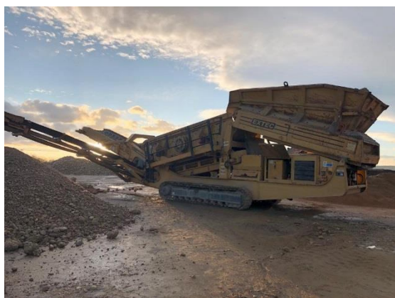
Scalpeur EXTEC E7 Année : 2006 – 7704 Heures – En Etat de fonctionnement Alimentateur métallique - Caisson vibrant équipé de doigts espacement 70 mm sur l'étage supérieur et grille maille carrée sur l'étage inférieur - Moteur Deutz – Autres équipements standards
