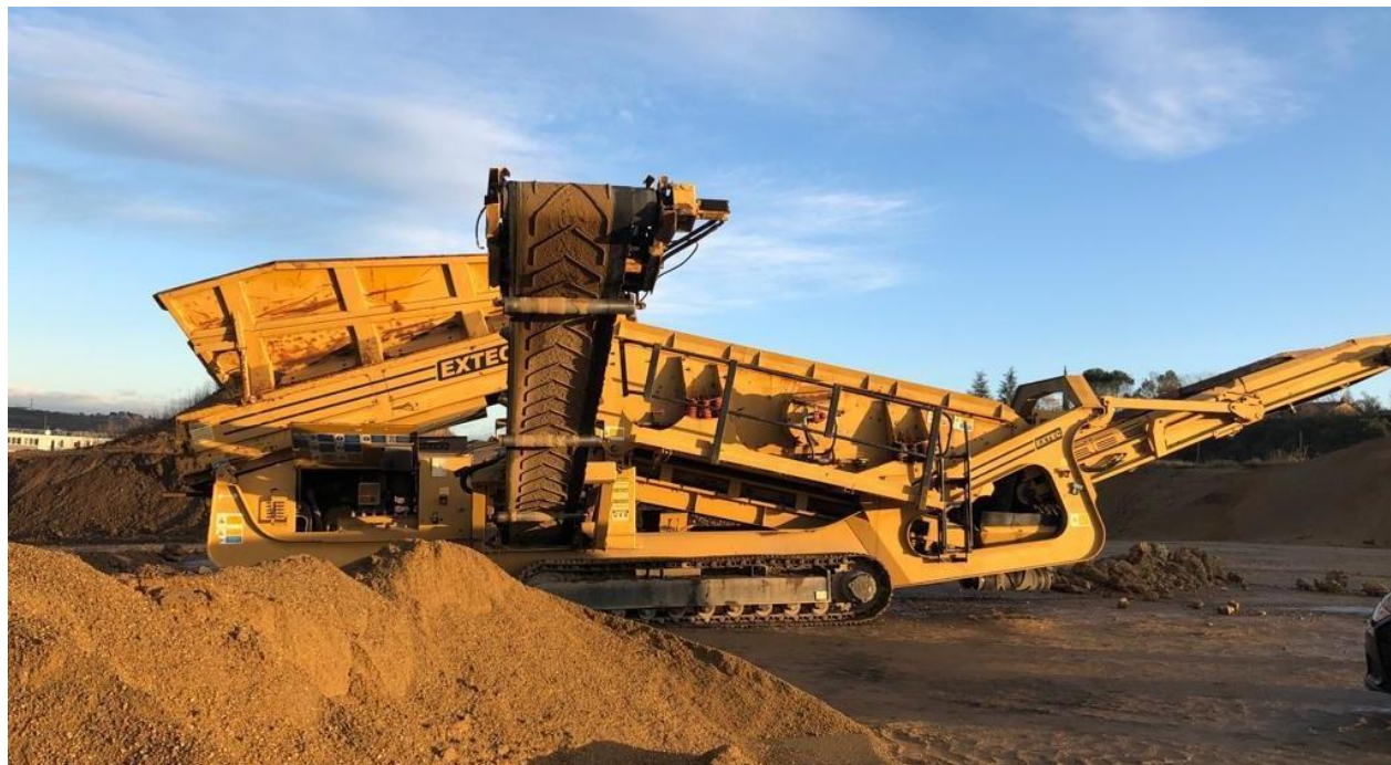
Scalpeur EXTEC E7 Année : 2006 – 7704 Heures – En Etat de fonctionnement Alimentateur métallique - Caisson vibrant équipé de doigts espacement 70 mm sur l'étage supérieur et grille maille carrée sur l'étage inférieur - Moteur Deutz – Autres équipements standards
