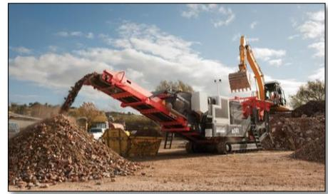
Le QJ241 es l'appareil le plus compact de la série. Spécialement conçu pour les petits chantiers, il est capable d'atteindre des cadences de production impressionnantes avec d'excellents taux de réduction.
