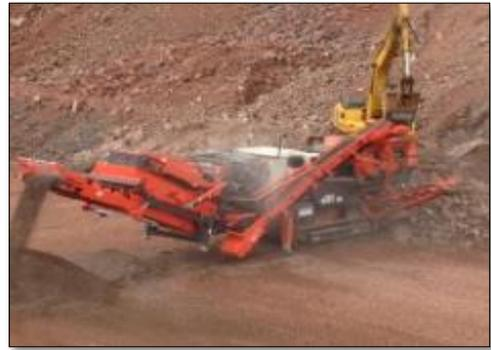
Équipé d'un percuteur CI411 Prisec™, le QI341 est la machine de taille moyenne la plus flexible et la plus économique sur le marché. Qu'il fonctionne en mode primaire ou secondaire, le 341 est conçu pour offrir un rendement massif tout en minimisant usure et coût d'exploitation. Le profil en faucille des marteaux qui est propre à Sandvik assure une réduction maximum des matériaux même lorsque les marteaux ont subi une certaine usure.
