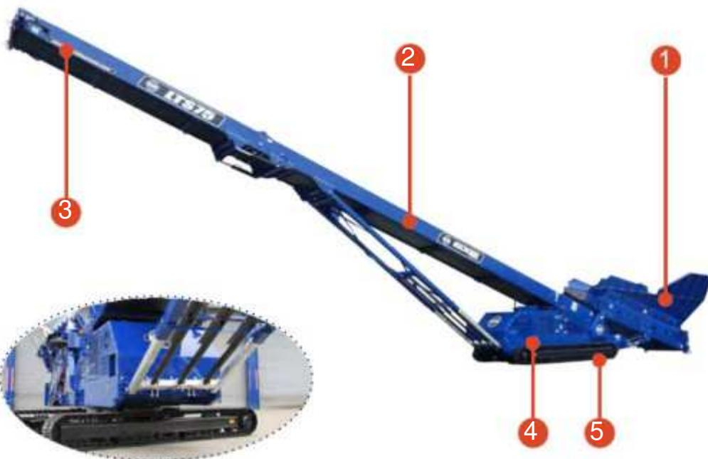
**1** Conçu spécifiquement pour permettre le chargement bas de matériaux à partir de chargeurs sur roues, de grues et d'excavatrices.
