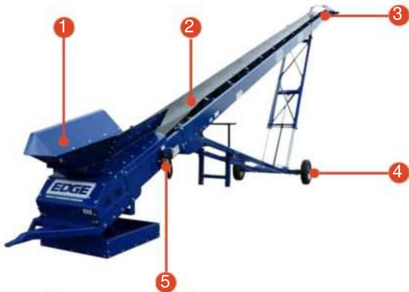
**1** Peut accepter des charges directement depuis les concasseurs, les cribles, les broyeurs ou les installations de nettoyage
