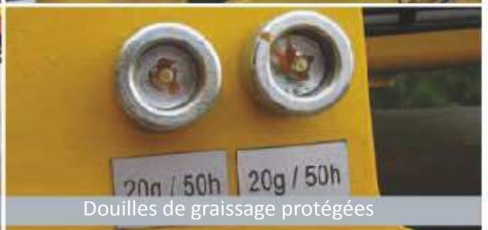
Douilles de graissage protégées
