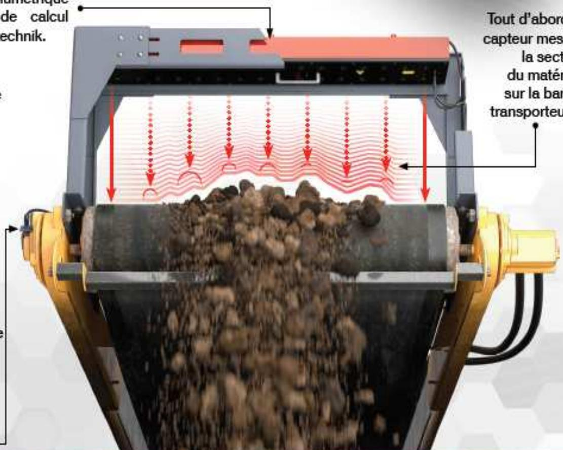
Tout d'abord le capteur mesure la section du matériau sur la bande transporteuse.
