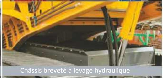
Châssis breveté à levage hydraulique
